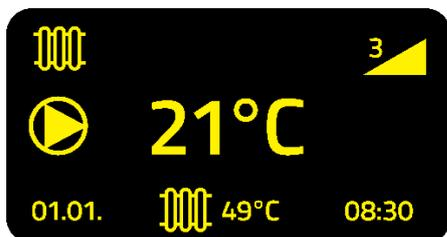
**Heizkreisbetrieb Heizkörper:** Hier ist der Heizkreis für Heizkörperbetrieb aktiv. Der Witterungsgeführte Modus ist nicht aktiv. Unten mittig sehen Sie die Solltemperatur des Kessels.
