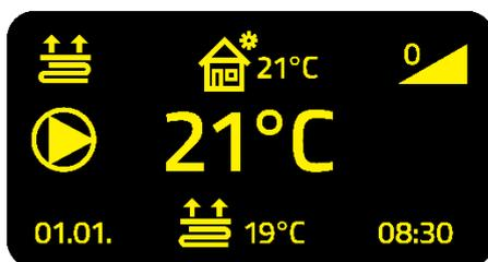
**Heizkreisbetrieb Fußbodenheizung:** Hier ist der Heizkreis für Fußbodenheizbetrieb aktiv. Der Witterungsgeführte Modus (Haussymbol) ist aktiv. Unten mittig sehen Sie die Solltemperatur des Kessels
