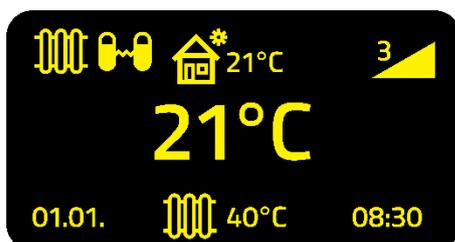
**Heizkreisbetrieb Heizkörper im Kaskadenmodus:** Hier ist der Heizkreis für Heizkörperbetrieb aktiv. Der Witterungsgeführte Modus (Haussymbol) ist aktiv. Links neben dem Haussymbol zu sehen ist der Kaskadenmodus. Hierbei ist die interne Umwälzpumpe (bei diesem Gerät nicht vorhanden) deaktiviert. Im Kaskadenmodus wird auf eine externe Umwälzpumpe zurückgegriffen.
