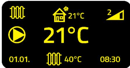
**Heizkreisbetrieb Heizkörper:** Hier ist der Heizkreis für Heizkörperbetrieb aktiv. Der Witterungsgeführte Modus (Haussymbol) ist aktiv. Unten mittig sehen Sie die Solltemperatur des Kessels.
