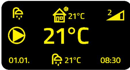
**Brauchwasserbetrieb:** Hier ist nur den Brauchwasserbetrieb aktiv. Der Witterungsgeführte Modus (Hausymbol) ist aktiv. Unten mittig sehen Sie die Ist-Temperatur des Brauchwassers.
