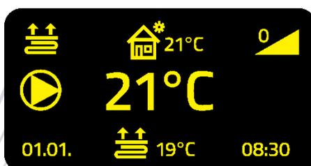
**Heizkreisbetrieb Fußbodenheizung:** Hier ist der Heizkreis für Fußbodenheizbetrieb aktiv. Der Witterungsgeführte Modus (Haussymbol) ist aktiv. Unten mittig sehen Sie die Solltemperatur des Kessels.
