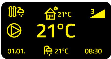
**Heizkreis Heizkörper- & Brauchwasserbetrieb:** Hier sind der Heizkreisbetrieb für Heizkörper und der Brauchwasserbetrieb aktiv. Der Witterungsgeführte Modus (Hausymbol) ist aktiv. Unten mittig sehen Sie die Ist-Temperatur des Brauchwassers.
