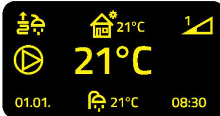
**Heizkreis Fußboden- & Brauchwasserbetrieb:** Hier sind der Heizkreisbetrieb für Fußbodenheizung und der Brauchwasserbetrieb aktiv. Der Witterungsgeführte Modus (Hausymbol) ist aktiv. Unten mittig sehen Sie die Ist-Temperatur des Brauchwassers.
