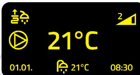
**Heizkreis Fußboden- & Brauchwasserbetrieb:** Hier sind der Heizkreisbetrieb für Fußboden und der Brauchwasserbetrieb aktiv. Der Witterungsgeführte Modus ist nicht aktiv. Unten Mittig sehen Sie die Ist-Temperatur des Brauchwassers.
