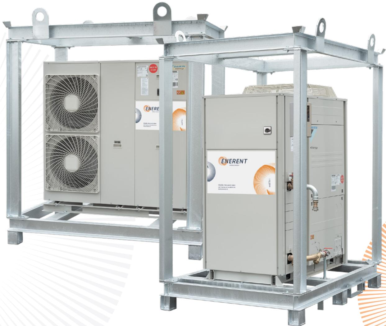
Luftgekühlter Mini-Kaltwassersatz mit Inverter. Inverter-Verdichter passen kontinuierlich die Verdichterdrehzahl an den tatsächlichen Bedarf an. Weniger energieverbrauchende Starts und Stops führen zu einem verringerten Energieverbrauch (bis zu 30%) und zu stabileren Temperaturen.
