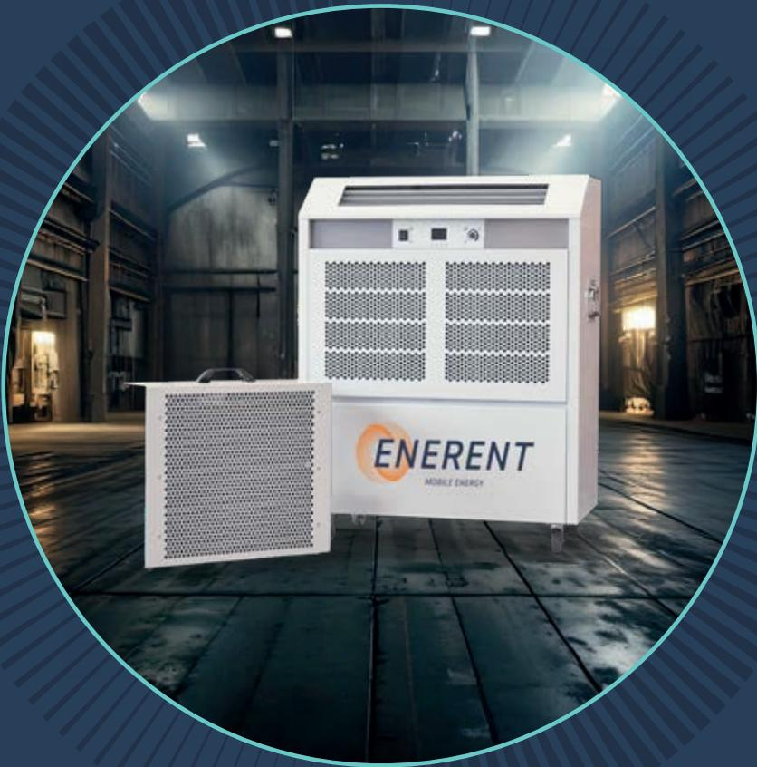
Der Kaltwassersatz mit 7 kW ist ein Split-Klimagerät. Die Abwärme des innen aufgestellten Gerätes wird an den externen Wärmetauscher geleitet. Die Verbindung der Innen- und Außeneinheit erfolgt durch flexible Verbindungsschläuche mit Schnellkupplungssystem. Die Standardverbindung ist 10 m lang und kann auf maximal 30 m verlängert werden. Durch den drehzahlregelbaren Ventilator der Inneneinheit kann der gekühlte Luftvolumenstrom relativ zugfrei reguliert werden.
