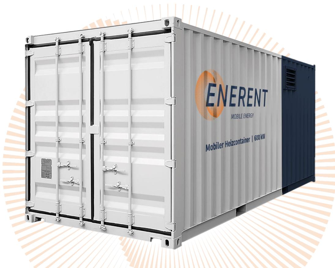
Der mobile Heizcontainer in Leichtbauweise fungiert als flexibler und leistungsstarker Wärmeerzeuger. Im Heizcontainer ist ein elektrisches Heizgebläse verbaut, welches vor Frost schützt. Der integrierte Zweistoffbrenner ist in der Lage, sowohl Öl als auch Gas zu verbrennen. Reicht das vorhandene Tankvolumen nicht aus, können externe Öltankanlagen angeschlossen werden. Einsatzgebiete: Heizungsausfälle, Arbeiten am Wärmeerzeuger, Frostsicherung, Vorsorge/Erstaufheizung und Estrichtrocknung.
